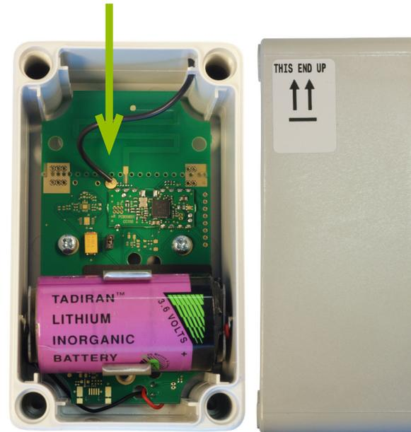
Sobald das Beacon an einer gewünschten Position montiert ist, kann es durch Einsetzen des Jumpers eingeschaltet werden. Sobald der Jumper angeschlossen ist, ist das Beacon betriebsbereit. Die LED blinkt im Übertragungsintervall. Wenn sich das Beacon im Konfigurationsmodus befindet, blinkt es im 2-Sekunden-Intervall mit zwei Farben.
