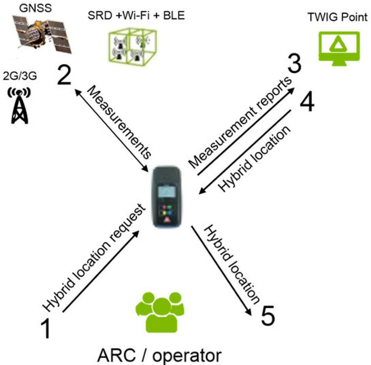
Die Genauigkeit der Hybridortung hängt von der eingestellten Übertragungsreichweite der erfassten Beacons, dem Standort des persönlichen Alarmgeräts zum Zeitpunkt der Positionsbestimmung und der Anzahl der Signale, die von mehreren nahegelegenen Beacons empfangen werden, ab.
